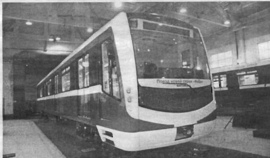
таких вагонах намного светлее — свет идет не от одиночных ламп, а по всей ширине вагона. Двери сейчас закрываются с такой силой, что те, кого хоть раз прищемило ими, знают, как это больно. В «НеВЕ» двери будут закрываться более плавно, применен специальный травмо-безопасный механизм. Станет легче дышать — вагоны оборудованы принудительной вентиляцией с функцией подогрева воздуха.
