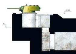
Построена в 1941–1942 гг. Стояла на бетонной тумбе, была вооружена 76-мм пушкой и двумя станковыми пулемётами. Сохранился чертёж. Возможно, была перестроена при строительстве рубежа «Ижора» в 1943 году. Это было единственное такого рода фортификационное сооружение в составе ОР «Ижора». Демонтирована после декабря 1944 г.
